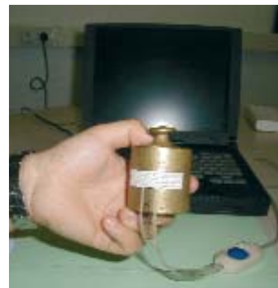
FIGURA 6. Sensor de fuerza en el modelo experimental de talón.
